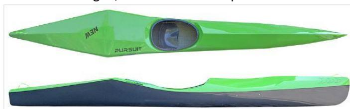
Un kayak manœuvrier a la capacité de changer rapidement de direction. Il est généralement court, plat et gironné. Les bateaux de slalom ou de polo sont manœuvriers.
